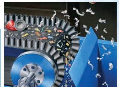
Wirkprinzip eines Wirbelstromscheiders (Abbildung mit freundlicher Genehmigung von Master Magnets Ltd.)
