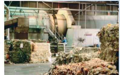
In Trommelpulpern werden Papierfasern gelöst
